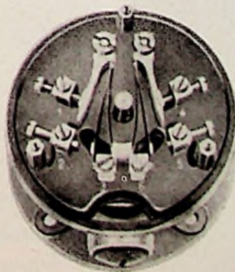
Het Alni draairichting-toerenrelais
