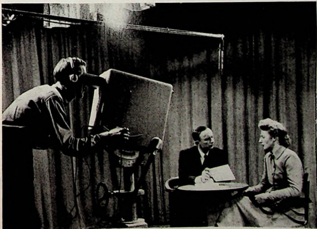
De microfoon in de televisiestudio heeft dezelfde taak als overal elders: het opvangen van het geluid. Het enige verschil bestaat hierin, dat de cameraman en de microfoontechnicus er angstvallig voor waken, dat de microfoon niet „in het beeld” komt.
